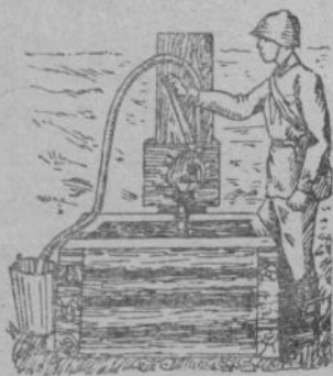
Рис. 183. Подъем воды насосом К Ф—2.
