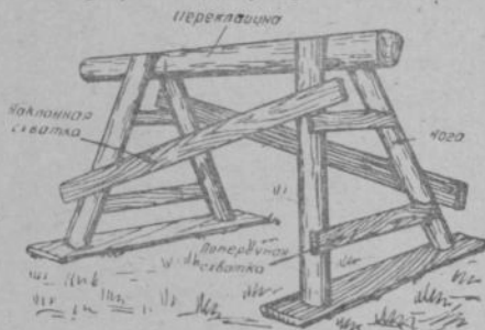
Рис. 170. Козла для промежуточной опоры
