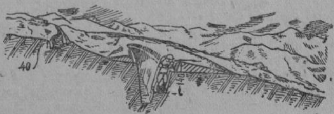
Рис. 71. Нагорная водоотводная канава. Время на отрывку одним бойцом 1 лог. м саперной лопатой—20 минут.
