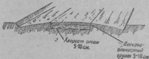
Рис. 139. Укрепление песчаных грунтов хворостом.
