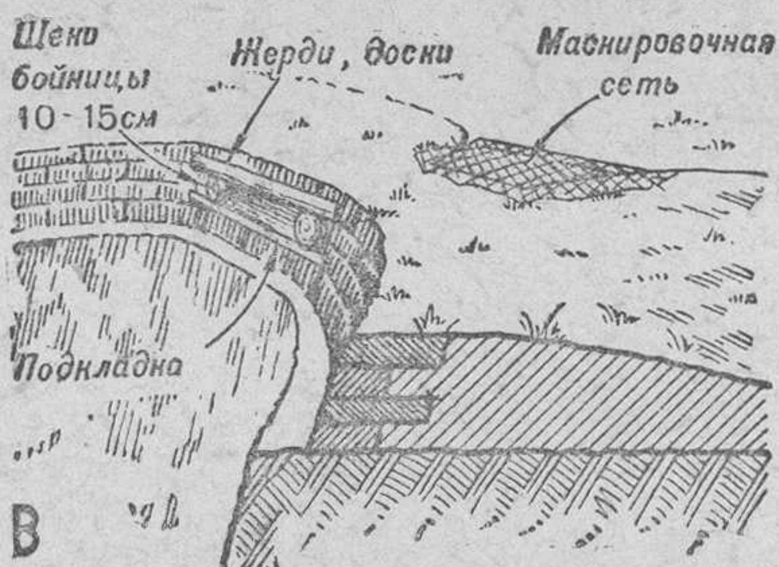
Рис. 43. Устройство покрытых бойниц:
