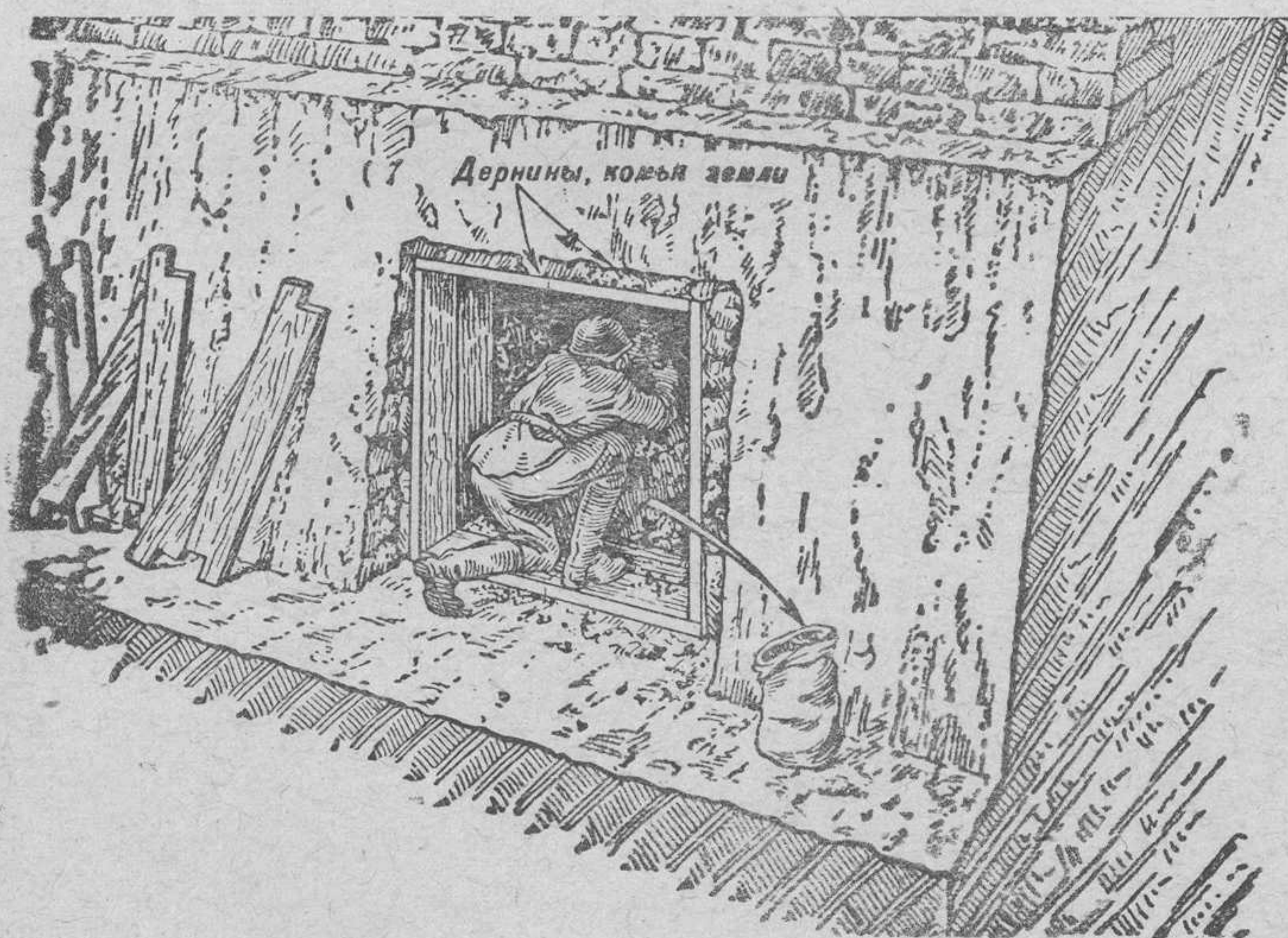
Рис. 51. Устройство одетой ниши для бойцов в среднем грунте. А — установка первой рамы; Б — отрывка земли для установки остальных рам.
