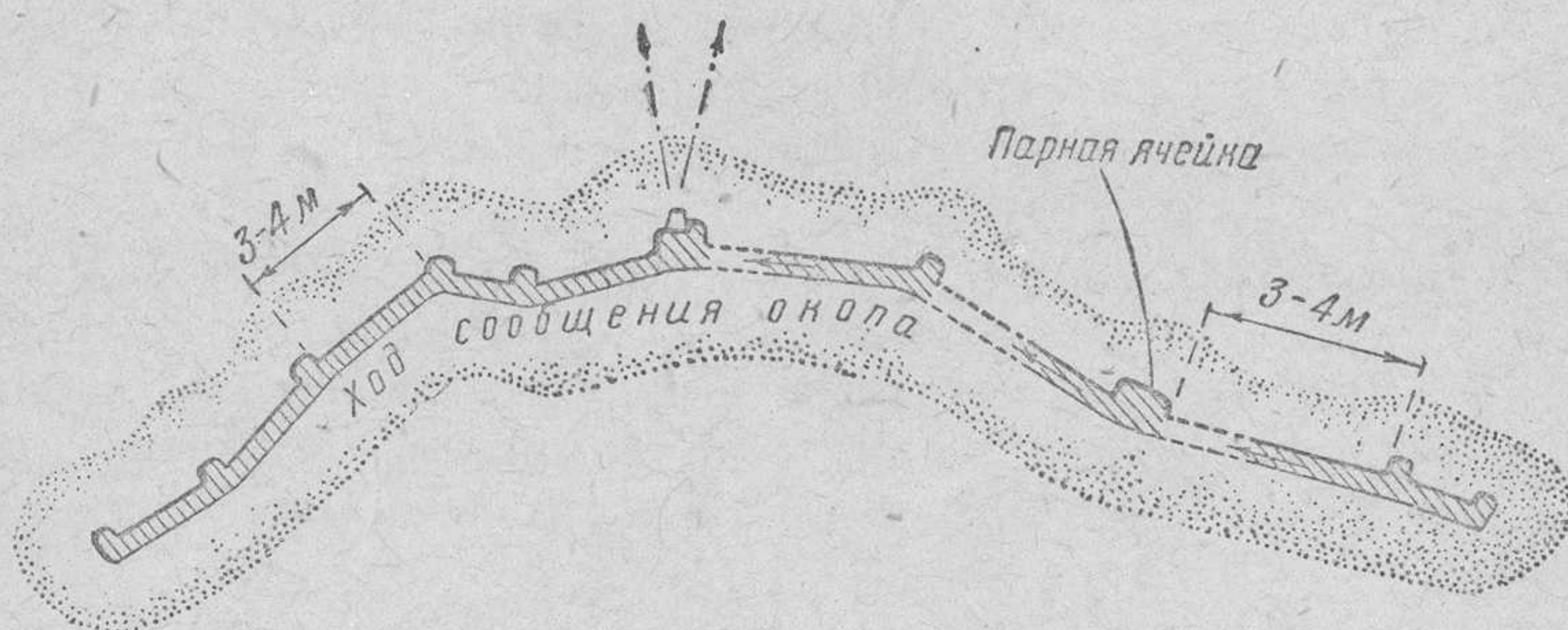
Рис. 2. Ячейковый окоп на стрелковое отделение
