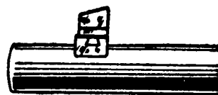
Рис. 11. Мушка винтовки прежних годов изготовления (с намушником на штыке)
