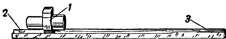
Рис. 20. Соединительная планка: 1 — стойка; 2 — сосок; 3 — вилка
