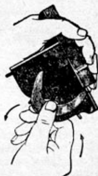
Рис. 73. Как отделить подъемные рычаги
