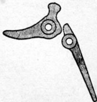
Рис. 60. Непроизвольная автоматическая стрельба: износ боевого взвода лодыжки или шпентала нижнего спуска
