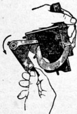
Рис. 72. Как отделить замочные рычаги
