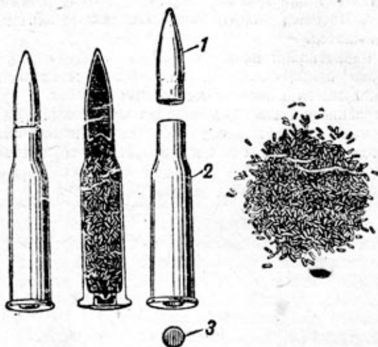
Рис. 51. Боевой патрон: 1 — пуля; 2 — гильза; 3 — капсюль
