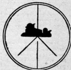
Рис. 89. Прямая наводка пулемета в цель по оптическому прицелу: верхняя треугольника совместилась с точкой наводки
